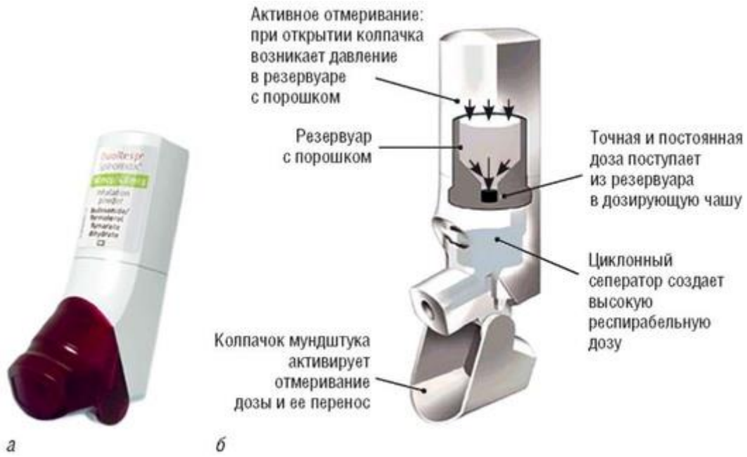
Рис. 7.10. Ингалятор Спиромакс: а - внешний вид; б - устройство
