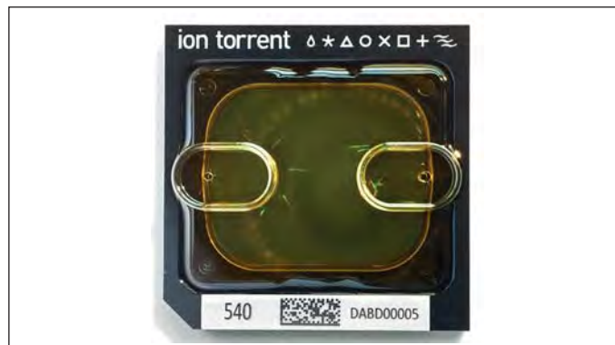
Рис. 5.3. Расходный элемент одного из видов секвенаторов NGS — чип, содержащий более 80 млн микроскопических ячеек, в каждой из которых проводится секвенирование короткого фрагмента ДНК. Данные с каждой ячейки собираются параллельно и анализируются программным обеспечением секвенатора.
