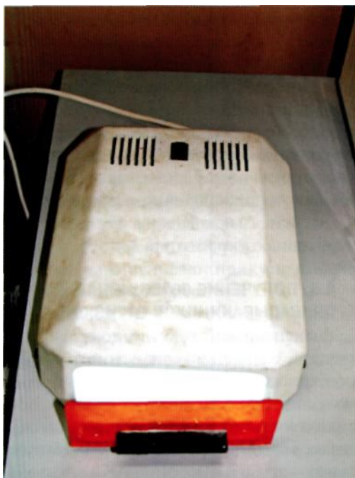
Рис. 4.4. Аппарат для светоотверждения индивидуальных ложек.
