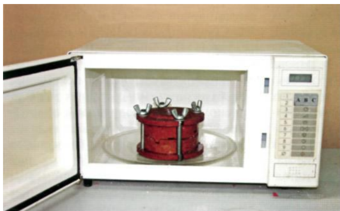
Рис. 15.1. Диэлектрическая кювета в микроволновой установке «Дента».
