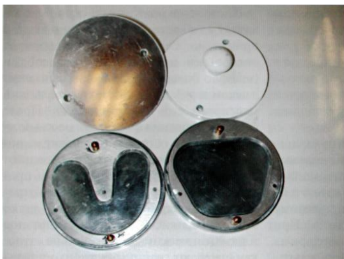
Рис. 4.2. Штампы и контршампы для изготовления индивидуальных ложек.
