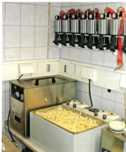
Рис. 15.5. Аппарат для полимеризации пластмасс холодной полимеризации.
